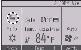
Cuando se muestra en la pantalla principal en el modo Completo, el sistema está controlado a nivel central y no se puede restaurar la señal del filtro.
