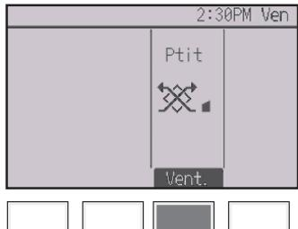
Chaque pression sur le bouton [F3] fait défiler les réglages de ventilation suivants.
