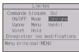
L'écran permettant de régler la fonction de verrouillage s'affiche.
