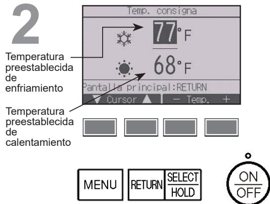
Pulse el botón [F1] o [F2] para desplazar el cursor al ajuste de temperatura deseado (enfriamiento o calentamiento).
