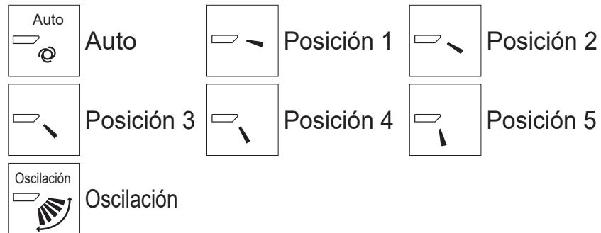
Seleccione “Oscilación” para que las lamas se muevan hacia arriba y hacia abajo automáticamente.
