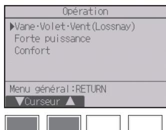
Sélectionnez « Vane•Volet•Vent(Lossnay) » dans le Menu de opération et appuyez sur le bouton **CHOIX**.
