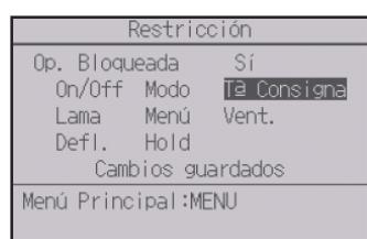
Aparecerá la pantalla para realizar la configuración de la función de bloqueo.
