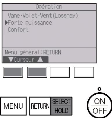
Sélectionnez « Forte puissance » dans le Menu de opération en mode refroidissement, chauffage ou automatique et pressez le bouton **CHOIX**.
