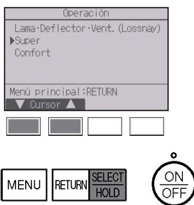
Seleccione “Super” en el menú de operación en funcionamiento en modo Frío, Calor o Auto y presione el botón **ACEPTAR**.
